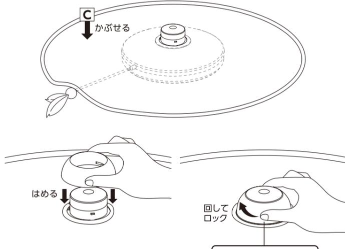
キャップを元の位置に戻し、外れないように回して取り付けます。
